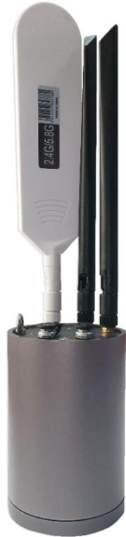
RAEM1 интеграционной версии с беспроводными синхронизированными часами при помощи WiFi
